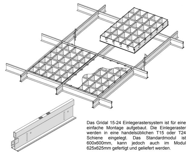
Überzeugend schnell und leicht zu montieren sowie zu demontieren, ergeben Gridal 15 (= für T15-Schienensystem) und Gridal 24 (= für T24-Schienensystem) Elemente in Verbindung mit der dazugehörigen T-Schiene eine Raster-Innendecke.
