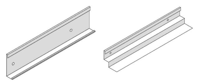
Der Wandanschluss erfolgt durch einen Wandwinkel aus kaltgewalzten 0,7mm starken Aluminium (linkes Foto), welcher in Rasterfarben beschichtet ist. Der Wandwinkel hat eine Abmessung von 40/20x4000mm.
